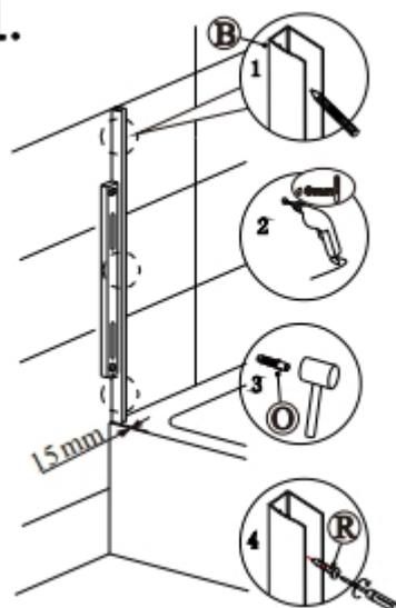
Je potrebné nechať 15 mm medzeru medzi okrajom stenového profilu a vonkajším okrajom vane, čo zaisťuje dostatočný priestor na namontovanie krytu zadržujúceho vodu
